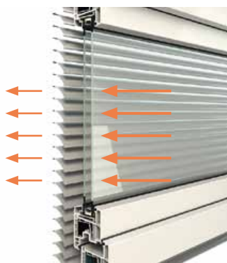
Zonwering aan de binnenzijde van het raam laat de meeste warmte binnen.
